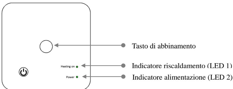
Il cronotermostato e la centralina ricevente creano un canale tra loro attraverso un codice binario. La centralina ha un tasto per ricercare l'ID del termostato, che a sua volta ha un tasto per legarsi alla centralina. Generalmente il collegamento tra i due è già impostato; in caso contrario, seguire le seguenti istruzioni per collegare i due dispositivi.
