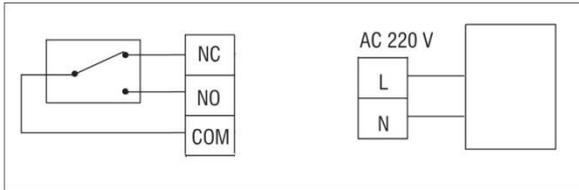
Tipologia B: diagramma con output a 230 V
