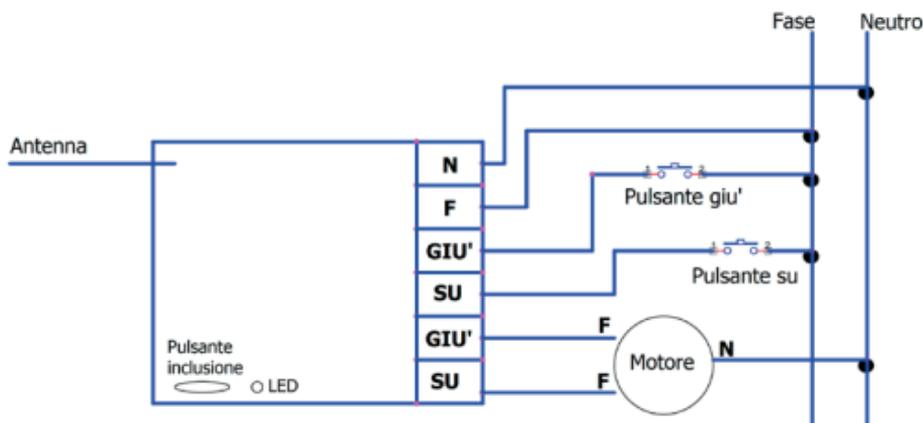
2. Per l'inclusione: lanciare il comando di inclusione del gateway MyVirtuoso Home (per tale operazione si segua il relativo manuale) e premere il pulsante di inclusione del dispositivo per 3 volte consecutive entro 1.5 sec., quindi il LED del dispositivo si spegne. Per l'esclusione: lanciare il comando di esclusione dal gateway MyVirtuoso Home e premere il pulsante di esclusione del dispositivo per 3 volte consecutive entro 1.5 sec., quindi il LED del dispositivo inizia a lampeggiare.
