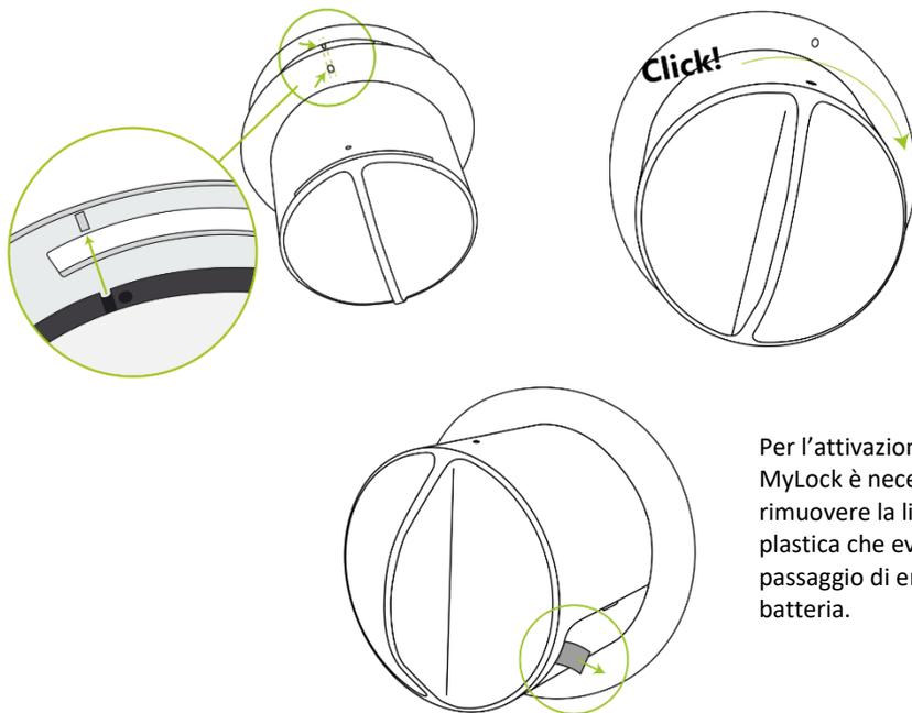
Per l'attivazione della MyLock è necessario rimuovere la linguetta di plastica che evita il passaggio di energia dalla batteria.
