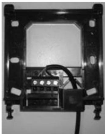
Per facilitare la fuoriuscita del cavo dal termostato eliminare la linguetta di plastica presente alla base del termostato (vedi immagine).
