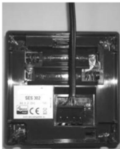
A questo punto inserire la parte terminale del cavo RJ10 nel sensore per tubi/serbatoi.
