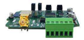
Figura 1: Antenna e Connettore verde
