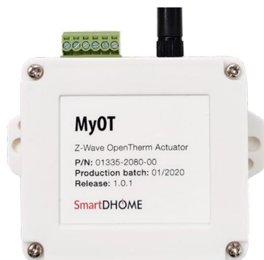
L'interfaccia/attuatore MyOT è un dispositivo specificamente sviluppato per **controllare i principali brand che producono caldaie di nuova generazione** che supportano il protocollo OpenTherm.
