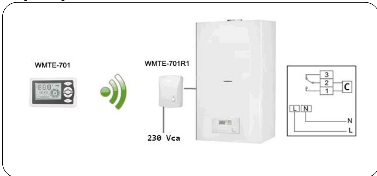
Fig. 1 Configurazione mono zona con caldaia autonoma
