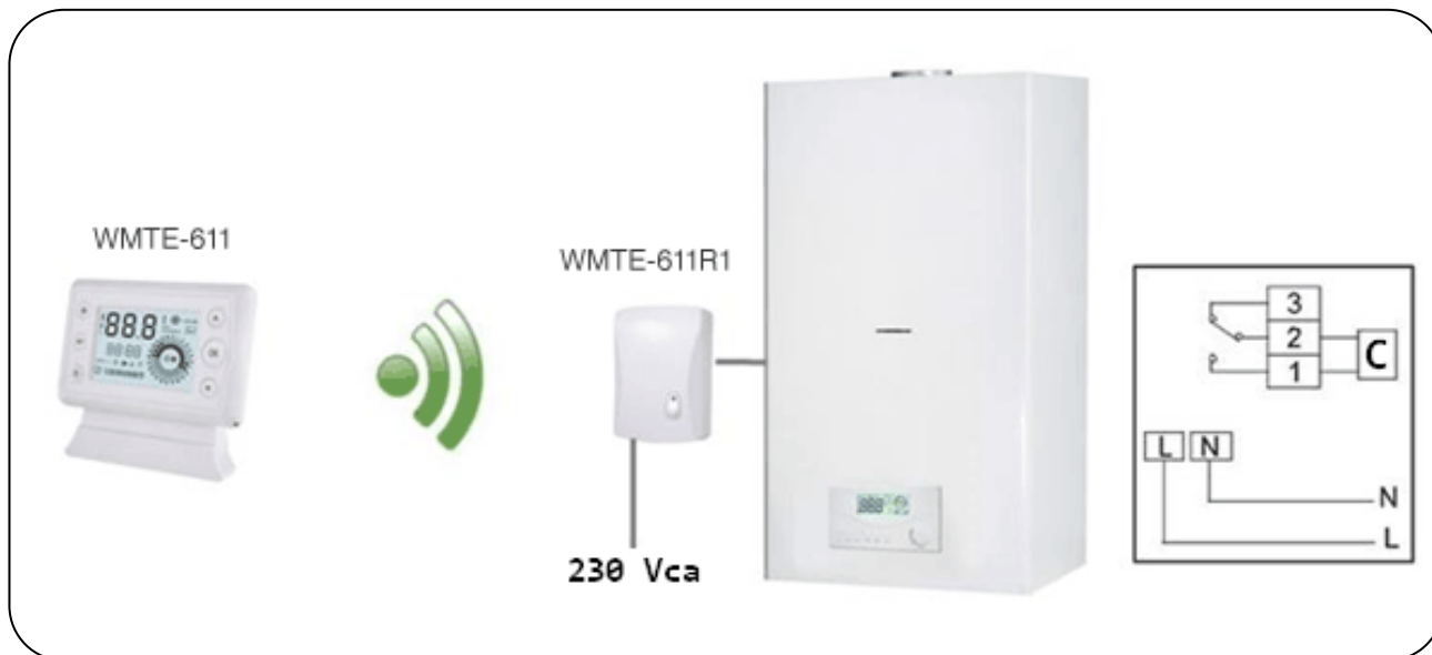
Fig. 1 Configurazione mono zona con caldaia autonoma
