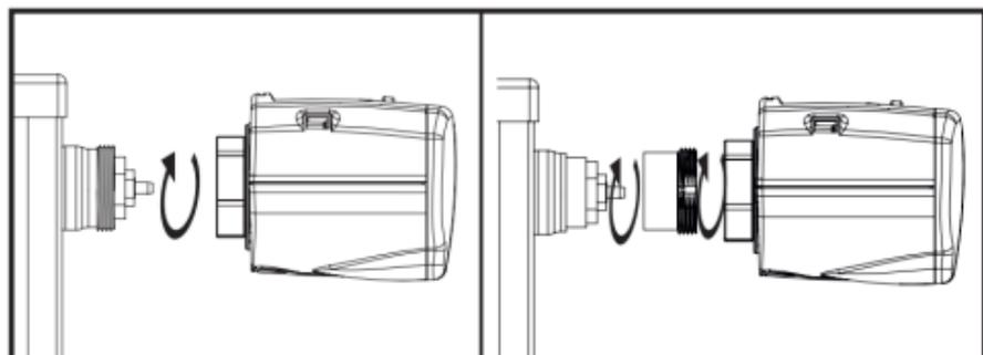
1. Svitare la testa termostatica manuale, allentare il fissaggio e rimuovere la testina dalla valvola.
