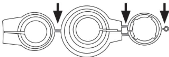
Rimuovere completamente le aste di connessione evidenziate in grigio, prima di assemblare fli adattatori. Puoi trovare ulteriori informazioni sulle valvole che necessitano di adattatori su:
