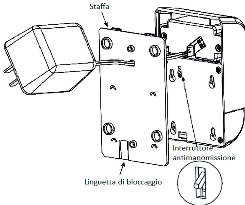
3. Rimuovere le 2 viti ed estrarre il coperchio di plastica come mostrato di seguito. Estrarre il jumper e rimetterlo in posizione in modo che i 2 pin siano coperti.
