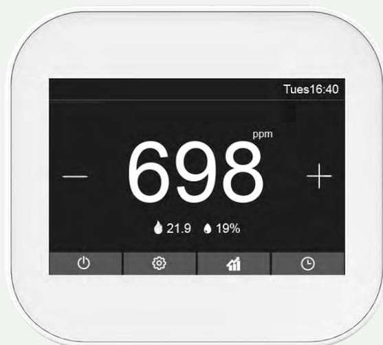
Il Monitor Wi-Fi/Modbus è un dispositivo della serie Comfort.me MFC adatto a contesti residenziali e lavorativi che rileva il livello di CO<sub>2</sub> nell'ambiente e gestisce sistemi di ventilazione forzata.
